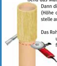
Das Rohr an der Schnittstelle – mittels Winkelschleifer und geeigneter Diamanttrennscheibe – umlaufend unter leichtem Druck anritzen/einschneiden. Danach das Rohr durchschneiden.
