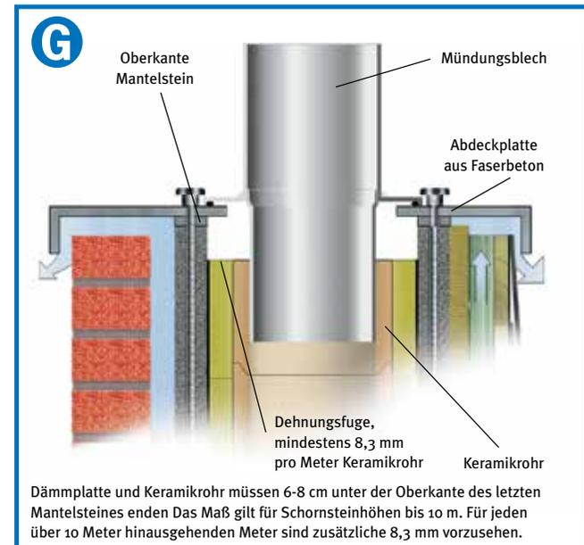
Dämmplatte und Keramikrohr müssen 6-8 cm unter der Oberkante des letzten Mantelsteines enden. Das Maß gilt für Schornsteinhöhen bis 10 m. Für jeden über 10 Meter hinausgehenden Meter sind zusätzliche 8,3 mm vorzusehen.
