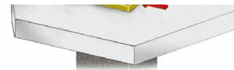
Die Deckenaussparung einer nichtbrennbaren, mineralischen Decke sollte umlaufend mindestens 50 mm größer als die Außenabmessungen des Mantelsteines vorgesehen werden. Im Aussparungsbereich eine nichtbrennbare, formstabile ca. 10-20 mm dicke Mineralfaser-Bauteiltrennplatte am Mantelstein anbringen. Den Spalt zwischen Deckenöffnung und Dämmplatte mit Beton verfüllen.
