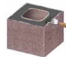
Betonformblöcke vor der Montage immer mit Wasser anfeuchten! Mörtel sorgfältig auftragen. Der Schacht (Schornsteinzug) ist grundsätzlich frei von Mörtel zu halten.
