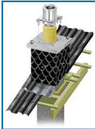
Einfassung wird i. d. R. in die Dachhaut eingebunden und lässt eine freie Längsbeweglichkeit des Schornsteins zu. Die Anschlussstelle am Schornstein wird vom Stülpkopf überdeckt. Kappleisten als oberer Abschluss können daher entfallen.
