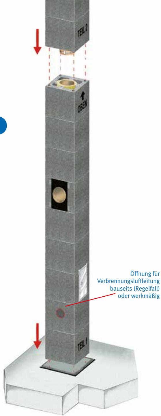
anfeuchten. Fugenkitt auf die Rohrnut des Keramikrohres auftragen. Mörtel, (mind. M 5 nach EN 998-2 / mind. NM IIa gem. DIN V 18580) mittels Versetzsablonen auf die Mantelsteinoberseite aufbringen **A**. Kantholz- oder Dachlattenzuschnitt auf das Keramikrohr legen **B**.
