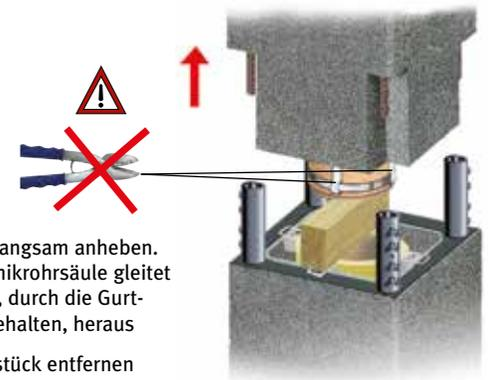
Element langsam anheben. Die Keramikrohssäule gleitet ca. 10 cm, durch die Gurtbänder gehalten, heraus
