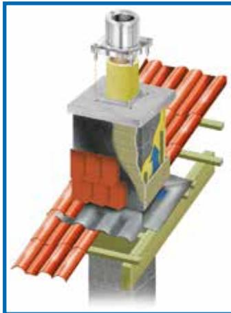
(von OK Dachhaut gemessen) am (ggf. gedämmten) Schornstein hochgezogen werden. Die Einfassung wird i. d. R. in die Dachhaut eingebunden und lässt eine freie Längsbeweglichkeit des Schornsteins zu. Die Anschlussstelle am Schornstein wird von der Kopfbekleidung überdeckt. Kappleisten als oberer Abschluss können daher entfallen.
