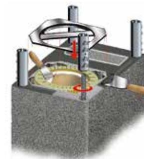
Bei Bedarf Elementverbinder montieren
